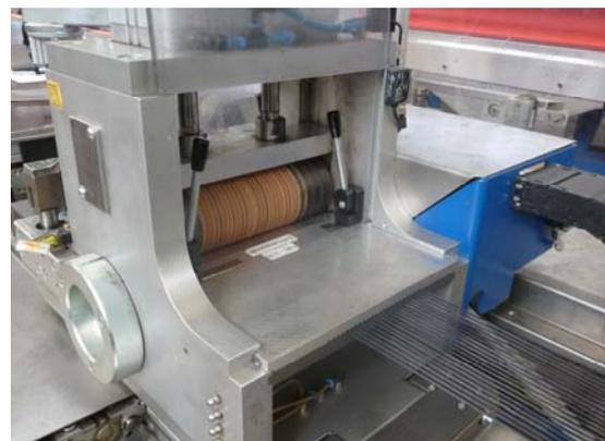
Antriebseinheit mit geöffneter Schutzscheibe
