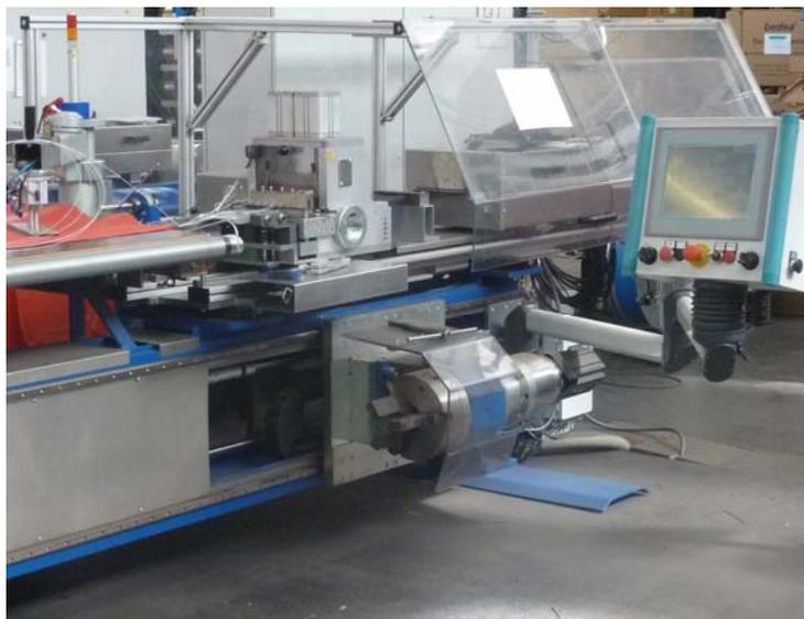
Angetriebene Lagereinheit mit Backenfutter auf der Bedienerseite
