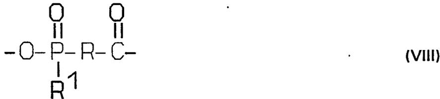
worin R Alkylen oder Polymethylen mit 2 bis 6 C-Atomen oder Phenyl und R<sup>1</sup> Alkyl mit 1 bis 6 C-Atomen, Aryl oder Aralkyl bedeutet, einkondensiert enthalten.
