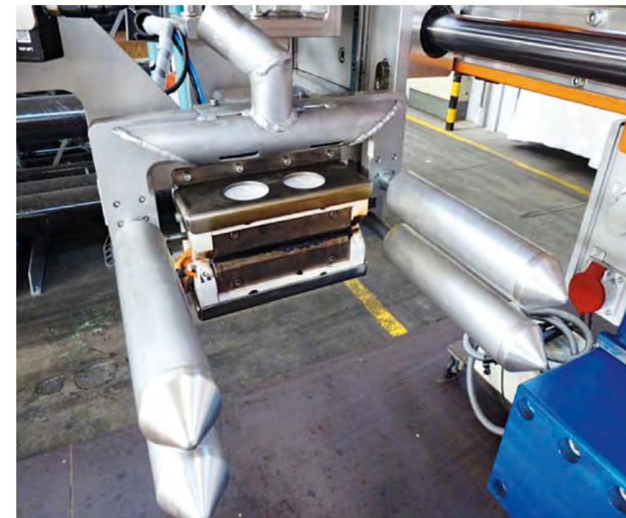
Führungsrollen mit mittig angeordneten austauschbaren Schweißbacken
