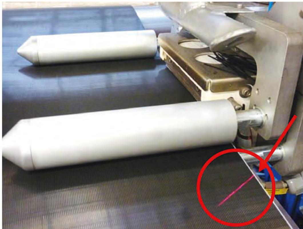
Kantenüberwachung während dem Schweißprozess
