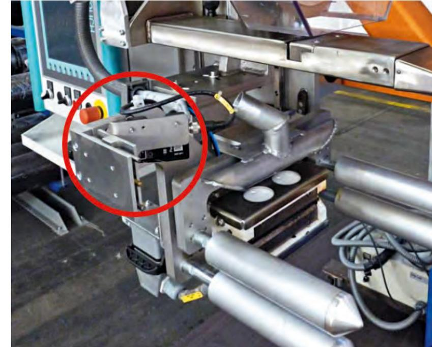
Kantensensor. Hier am linken Schneid- und Schweißgerät
