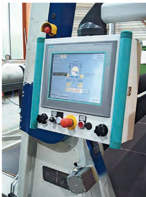
Bedienpanel der Anlagensteuerung
