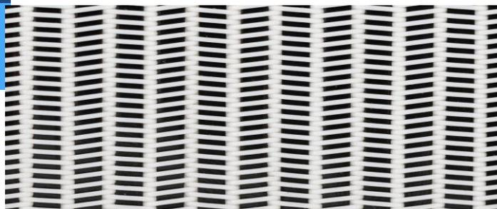
Abmessung Spiraldraht: **0,60** mm
