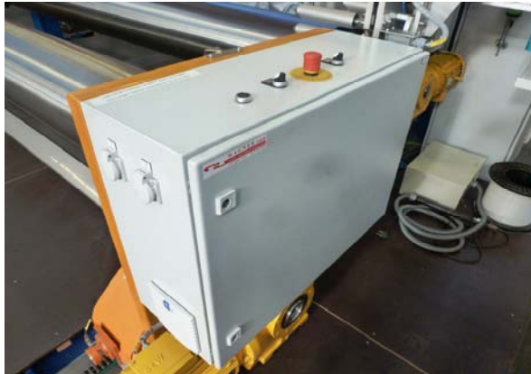
Schaltkasten mit Bedienelementen auf der Loslagerseite ...
