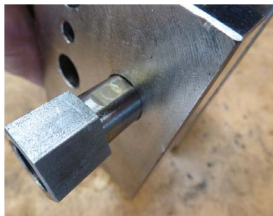
Bild 11 Einsetzen des Kleber-Anschlusses (Klemmfläche zeigt nach oben!)
