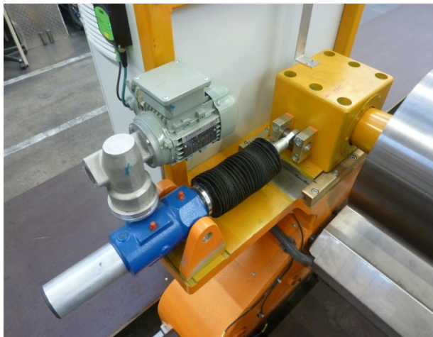
Steuerungsseitige Korrekturvorrichtung der Spannwalze mit Stellmotor und Skala für die aktuelle Walzenstellung
