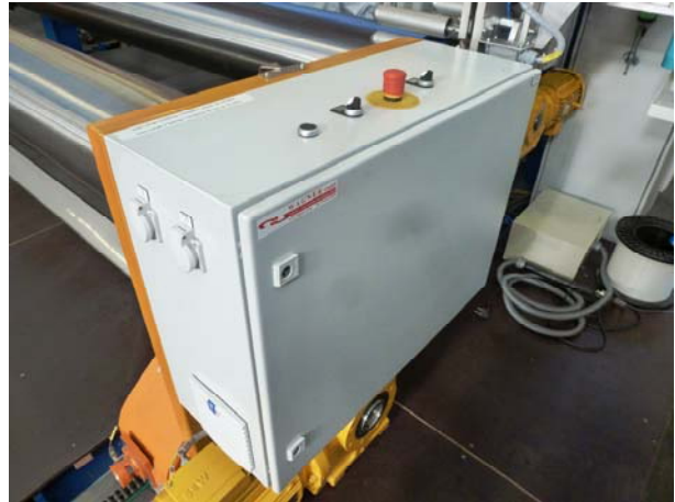
Schaltschrank mit Bedienelementen (Steuerungsseite)
