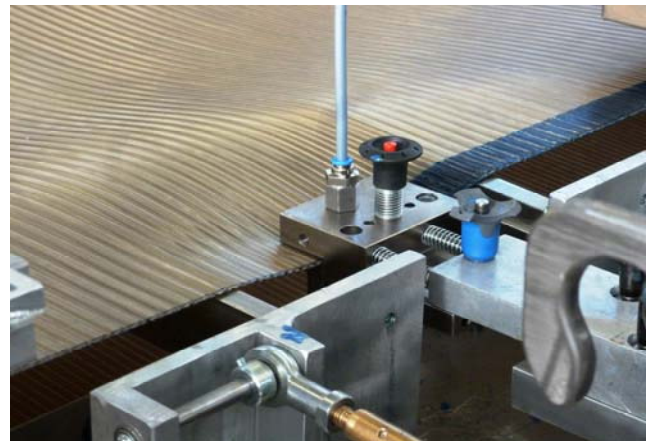
Bild 15 Optimale Höheneinstellung der Klebedüse
