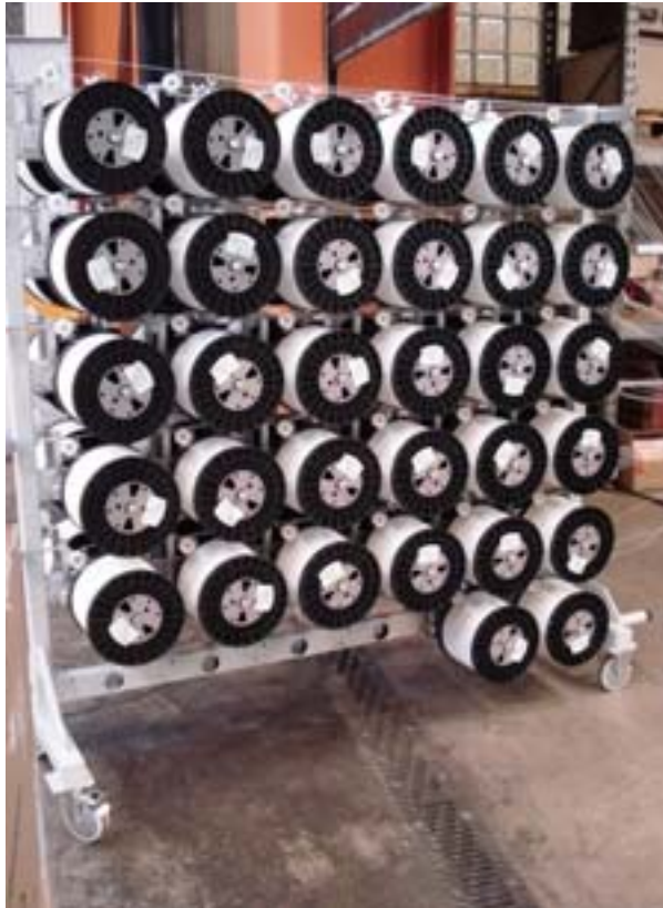
Fertig gerüstetes Spulengatter
