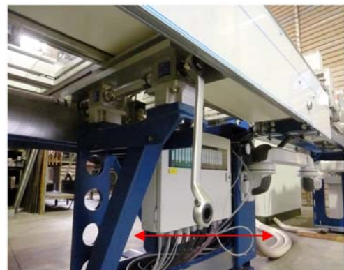
Umschaltbare Ratsche zur synchronen Höhenverstellung der Transportbänder
