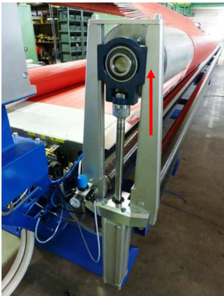
Umlenkwalze anheben und Sieb durchziehen
