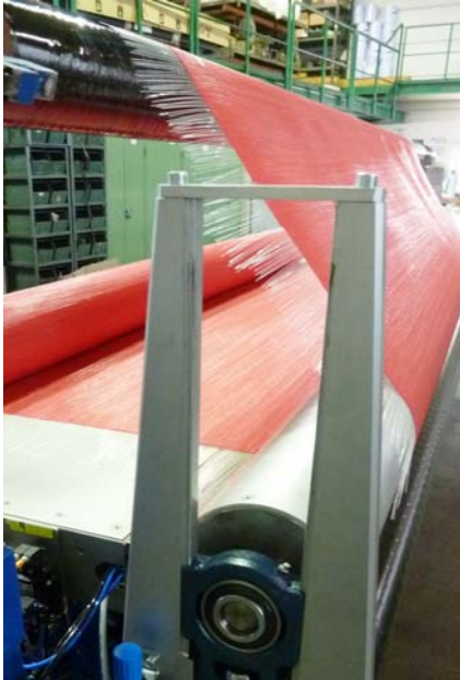
Nach Erreichen einer entsprechenden Sieblänge auflegen auf das Wickelrohr
