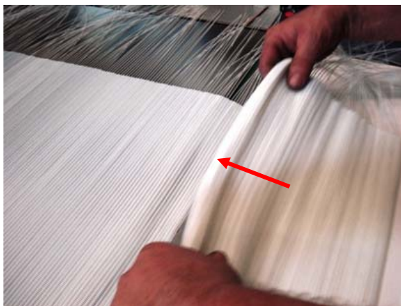
Entnahme des gefertigten Siebabschnitts aus dem Fügekanal und anlegen an das Siebende
