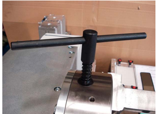
Backenfutterschlüssel zum Spannen und Lösen der Wickelrohre
