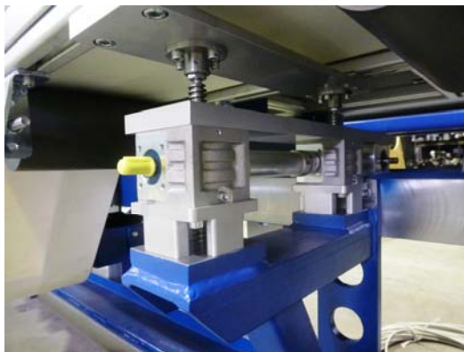
Hubelement zur synchronen Höhenverstellung der Transportbänder (bei demontierter Frontabdeckung)
