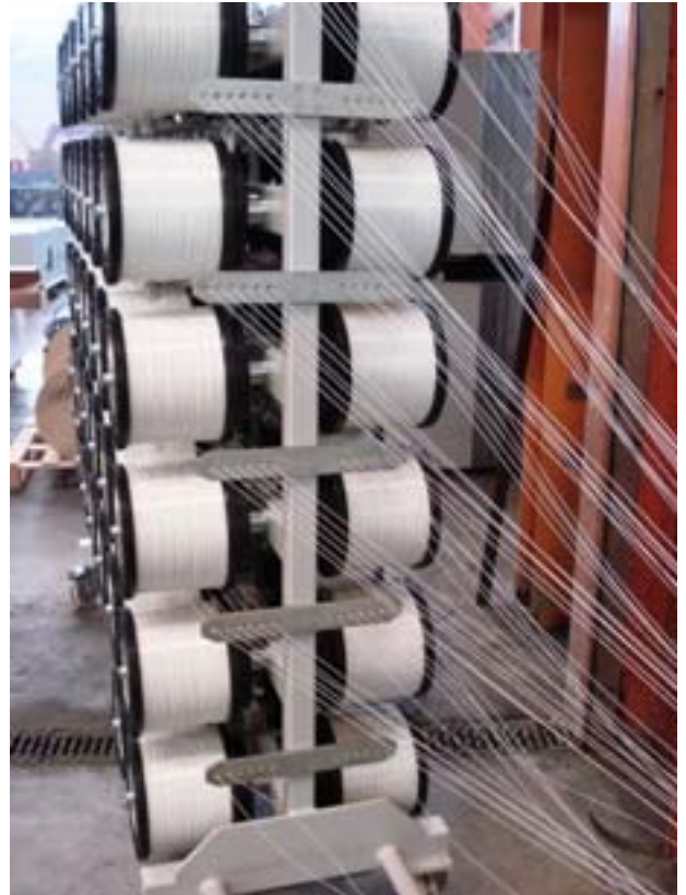
Drahtführung durch die Führungsösen
