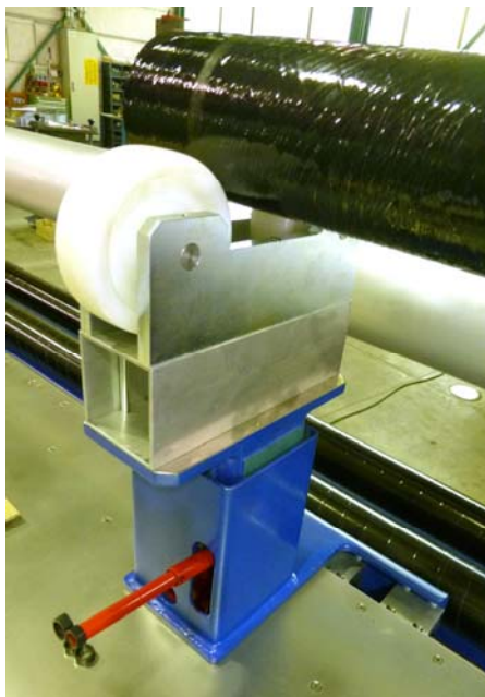
Verschiebbare Konsole zur individuellen Anpassung an unterschiedlich lange Wickelrohre
