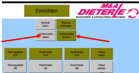
Heben und Absenken der Umlenkrolle im Menü „Einrichten“
