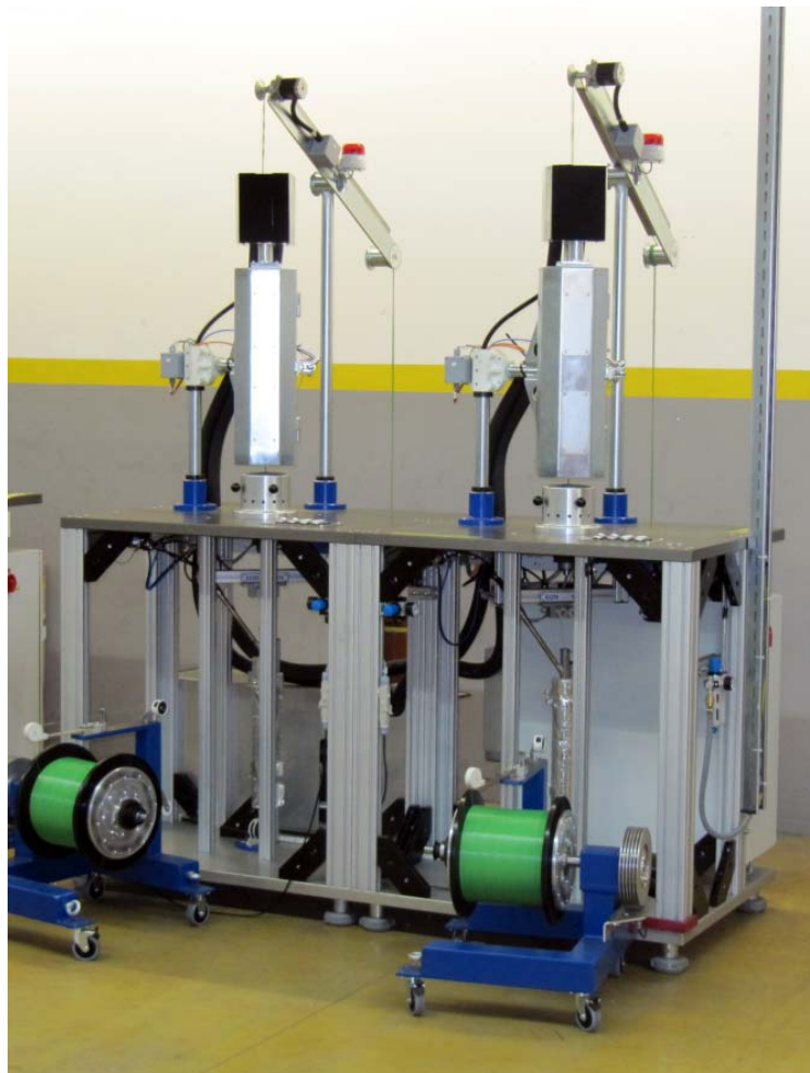
Hochleistungs-Spiralmaschine mit jeweils unabhängig arbeitender linker und rechter Spindel
